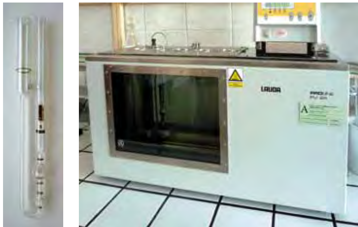
Рис. 2.16 Вид капиллярного вискозиметра типа BS/IP/RF и аппаратуры, в которой проводится испытание на кинематическую вязкость (фот. ООО «ОРЛЕН Асфальт», любезно предоставлено ООО «ОРЛЕН Лаборатория»)
