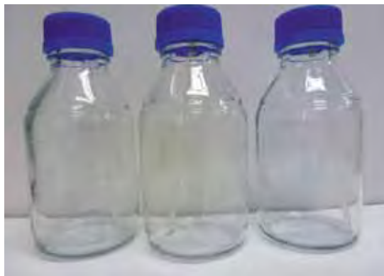
Рис. 2.32. Буылки для испытания отмытия вяжущего от наполнителя по методу А в аппарате для обкатки согласно PN-EN 12697-11 (фот. ООО «ОРЛЕН Асфальт»)
