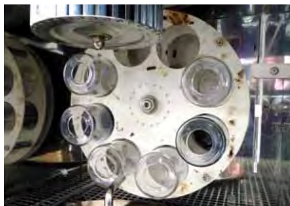
Рис. 2.25. Стеклянные контейнеры для образцов битума (А) и емкости, размещенные в печи, для проведения теста RTFOT (В) (фот. ООО «ОРЛЕН Асфальт», любезно предоставлено ООО «ОРЛЕН Лаборатория»)
