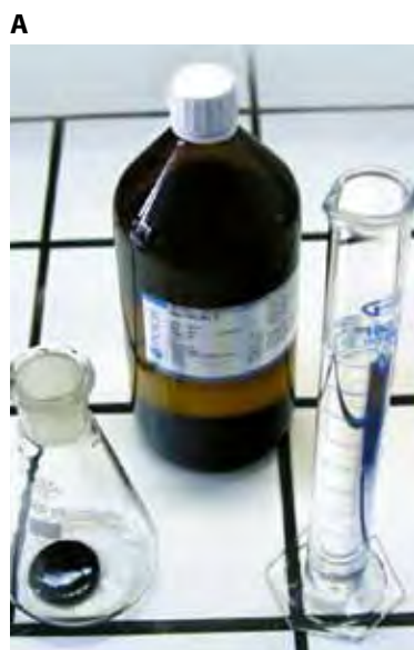
Рис. 2.12. Общий вид оборудования для испытания на растворимость (фот. ООО «ОРЛЕН Асфальт», любезно предоставлено ООО «ОРЛЕН Лаборатория»)
