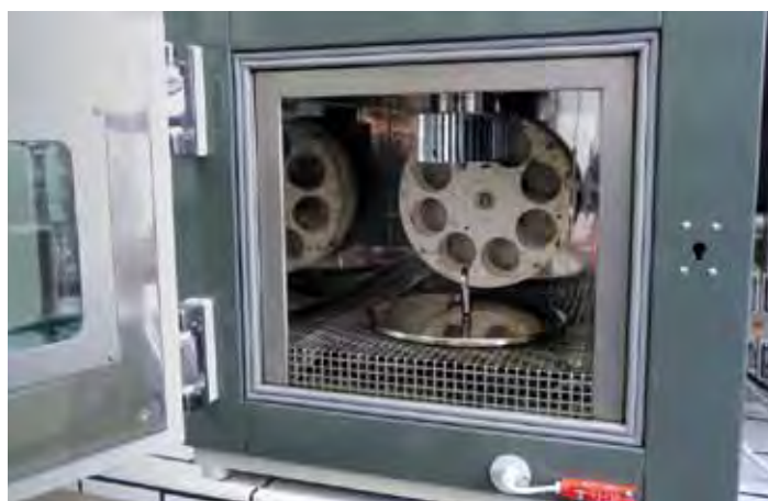
Рис. 2.24. Общий вид аппаратуры для проведения тестирования технологического старения RTFOT (фот. ООО «ОРЛЕН Асфальт», любезно предоставлено ООО «ОРЛЕН Лаборатория»)
