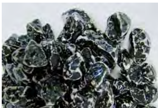
Рис. 2.33. Образцы минерального наполнителя после проведения испытания по методу А согласно PN-EN 12697-11 (фот. ООО «ОРЛЕН Асфальт»)
