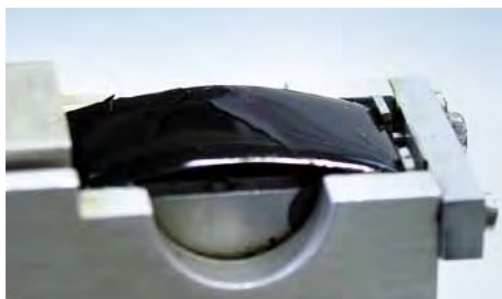
Рис. 2.9. Вид образцов битума на пластине, размещенных в полуавтоматическом аппарате, до и после проведения испытания – видна трещина в слое битума (фот. ООО «ОРЛЕН Асфальт», любезно предоставлено ООО «ОРЛЕН Лаборатория»)
