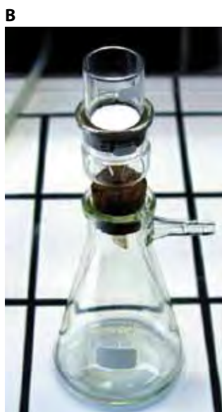
Рис. 2.12. Общий вид оборудования для испытания на растворимость (фот. ООО «ОРЛЕН Асфальт», любезно предоставлено ООО «ОРЛЕН Лаборатория»)
