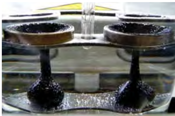
Рис. 2.6. Вид образца битума после проведения испытания (фот. ООО «ОРЛЕН Асфальт», любезно предоставлено ООО «ОРЛЕН Лаборатория»)
