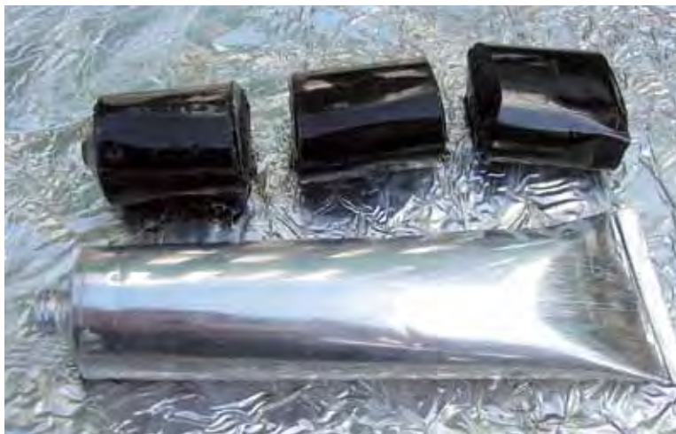
Рис. 2.31. Общий вид наполненной и закрытой трубки для проведения «проверки в трубке» и разрезанного на 3 части образца модифицированного битума (фот. ООО «ОРЛЕН Асфальт», любезно предоставлено ООО «ОРЛЕН Лаборатория»)
