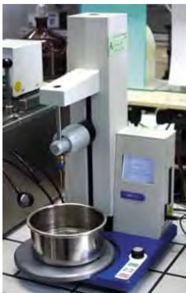
Рис. 2.2. Общий вид аппаратуры для испытания на пенетрацию с размещенным образцом битума (фот. ООО «ОРЛЕН Асфальт», любезно предоставлено ООО «ОРЛЕН Лаборатория»)
