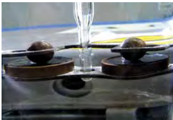
Рис. 2.6. Вид образца битума после проведения испытания (фот. ООО «ОРЛЕН Асфальт», любезно предоставлено ООО «ОРЛЕН Лаборатория»)
