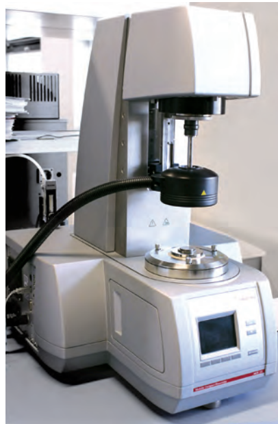
Rys. 8.1. Reometr DSR do badania MSCR (fot. ORLEN Asphalt dzięki uprzejmości ORLEN Laboratorium sp. z o.o.)
