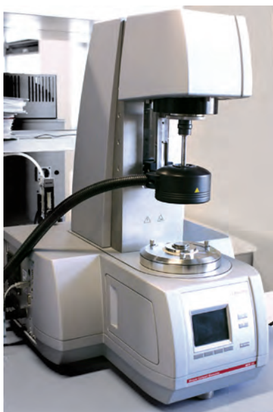
Rys. 13.3. Reometr dynamicznego ścinania DSR (fot. ORLEN Asphalt sp. z o.o. dzięki uprzejmości ORLEN Laboratorium sp. z o.o.)
