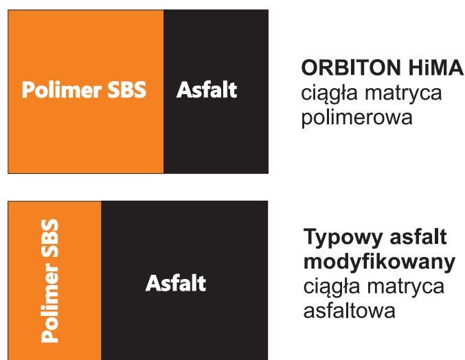
Rys. 5.1. Proporcje objętościowe między asfaltem a polimerem w typowym polimeroasfalcie i w asfalcie wysokomodyfikowanym
