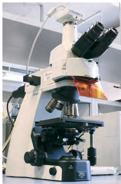
Rys. 13.4. Mikroskop fluorescencyjny z lampą UV do badania mikrostruktury asfaltów (fot. ORLEN Asphalt sp. z o.o. dzięki uprzejmości ORLEN Laboratorium sp. z o.o.)
