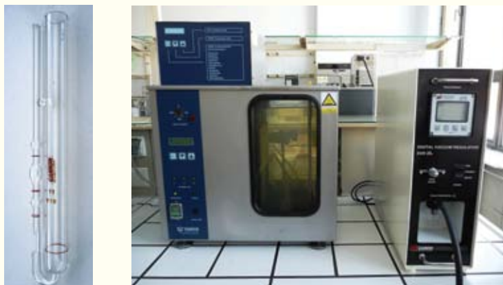
Rys. 5.6. Widok ogólny lepkościomierza próżniowego Cannon-Manning oraz aparatury w której przeprowadzane jest badanie lepkości dynamicznej (fot. ORLEN Asphalt sp. z o.o., dzięki uprzejmości ORLEN Laboratorium sp. z o.o.)
