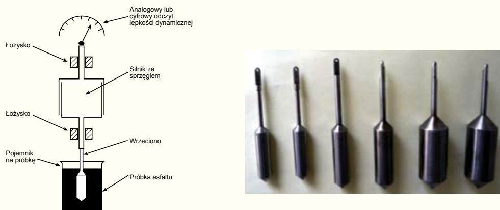
Rys. 5.11. Schemat lepkościomierza Brookfielda oraz widok ogólny wrzecion o różnych współczynnikach kształtu (fot. ORLEN Asphalt sp. z o.o., dzięki uprzejmości ORLEN Laboratorium sp. z o.o.)
