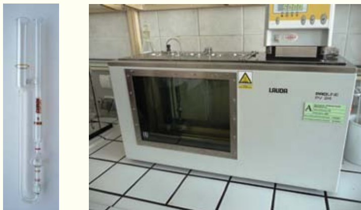
Rys. 5.4. Widok lepkościomierza kapilarnego typu BS/IP/RF oraz aparatury w której przeprowadzane jest badanie lepkości kinematycznej (fot. ORLEN Asphalt sp. z o.o., dzięki uprzejmości ORLEN Laboratorium sp. z o.o.)
