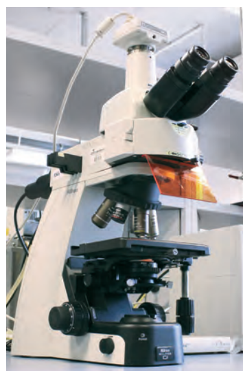
Рис. 12.4. Флюоресцентный микроскоп с ультрафиолетовой лампой для исследования микроструктуры битума (фото «ORLEN Asphalt», предоставленное ООО «ORLEN Laboratorium Sp. z o.o.»)
