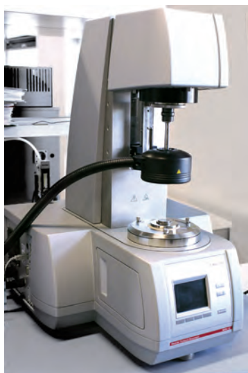
Рис. 12.3. Реометр динамического сдвига DSR (фото «ORLEN Asphalt», предоставленное ООО «ORLEN Laboratorium Sp. z o.o.»)
