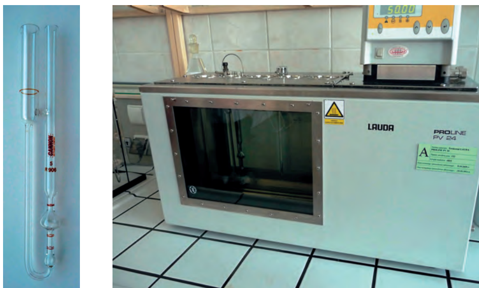
Figura 13.4. Vedere a viscozimetruului capilar de tip BS/IP/RF și a aparaturii în care este efectuată determinarea viscozității cinematice (fot. ORLEN Asphalt sp. z o.o., mulțumită amabilității ORLEN Laboratorium sp. z o.o.)
