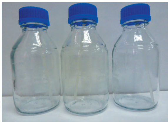
Figura 2.21. Sticlele pentru încercarea spălării liantului de pe agregat prin metoda A pe aparatul de rotire conform EN 12697-11 (fot. ORLEN Asphalt sp. z o.o.)
