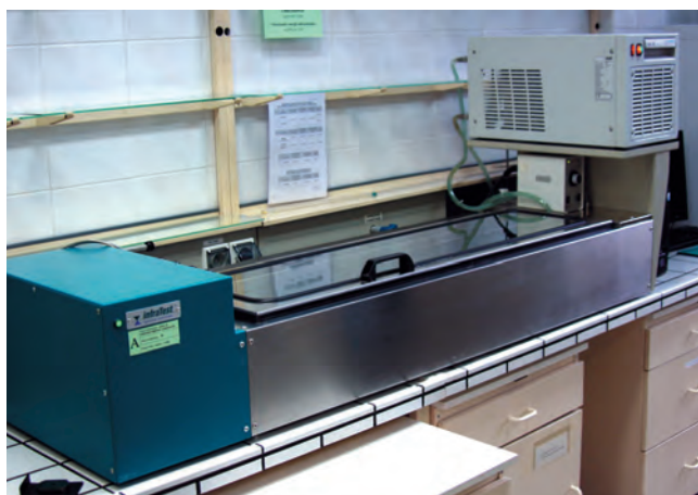
Figura 2.16. Vedere de ansamblu a aparaturii pentru determinarea revenirii elastice (fot. ORLEN Asphalt sp. z o.o. mulțumită amabilității ORLEN Laboratorium sp. z o.o.)
