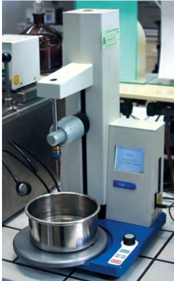
Figura 2.2. Vedere de ansamblu a aparatului de determinare a penetrației cu proba de bitum amplasată (fot. ORLEN Asphalt sp. z o.o. mulțumită amabilității ORLEN Laboratorium sp. z o.o.)
