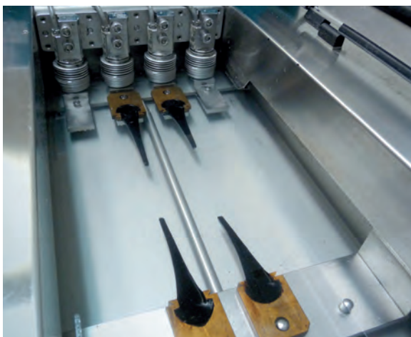
Figura 2.17. a) Vedere a probei de bitum modificat în forme înainte de începerea analizei, b) probele după întindere și tăiere, în timpul revenirii (fot. ORLEN Asphalt sp. z o.o. mulțumită amabilității ORLEN Laboratorium sp. z o.o.)
