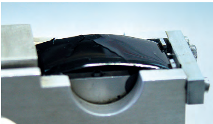
Figura 2.9. Vedere a probei de bitum pe placa introdusă în aparatul automat după efectuarea analizei – fisurare vizibilă a stratului de bitum (fot. ORLEN Asphalt sp. z o.o. mulțumită amabilității ORLEN Laboratorium sp. z o.o.)
