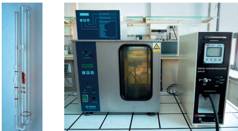
Figura 13.6. O vedere de ansamblu a viscozimetruului vacuum Cannon-Manning și a aparaturii în care a fost efectuată determinarea viscozității dinamice (fot. ORLEN Asfalt sp. z o.o., mulțumită amabilității ORLEN Laboratorium sp. z o.o.)
