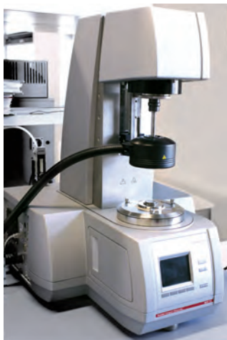
Fig. 12.3. Reometru dinamic de forfecare DSR (foto. ORLEN Asphalt SRL mulțumită amabilității ORLEN Laboratorium SRL)
