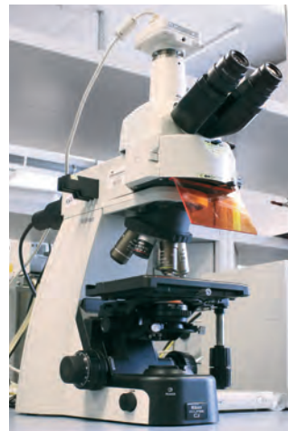
Fig. 12.4. Microscop fluorescent cu lampă UV pentru analiza microstructurii biturilor (foto. ORLEN Asphalt SRL mulțumită amabilității ORLEN Laboratorium SRL)
