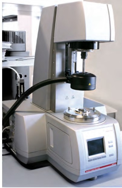
Figura 7.1. Reometru DSR pentru încercarea MSCR (fot. ORLEN Asphalt, mulțumită amabilității ORLEN Laboratorium S.R.L.)
